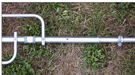
Bild 5: Äußere Enden zweier Linearinduktivitäten, dazwischen das Isolierstück Fotos: DK7CX (1), DL7VEE (3)
