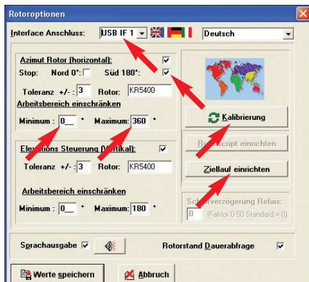
Bild 3: Hier sind verschiedene Einstellungen zu tätigen; obendrein lässt sich sogar der Drehbereich einschränken, wenn auf dem Dach etwas im Wege ist.
