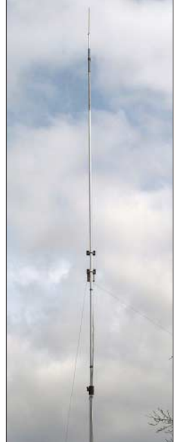
Bild 7: Sperrkreis-Vertikalantenne beim Abgleich
