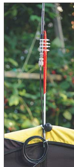
Bild 6: Eine 5/8-λ-Duo-Band-Teleskopantenne für das 2-m- und 70-cm-Band wurde mit Kabelbindern an der gekürzten Fahnenstange des Anhängers befestigt und in den seitlichen Halterungskanal geschoben. Als Gegengewicht dienten einige Windungen des Koaxialkabels RG58.
