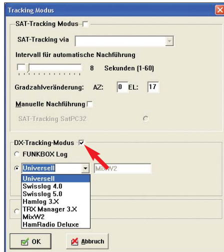
Bild 7: WinRotor arbeitet mit vielen Programmen zusammen, die hier auszuwählen sind. Für UcxLog gilt Universell, auch wenn hier MixW2 ausgewiesen wird.
