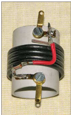
Bild 6: Sperrkreis für 28,4 MHz aus Koaxialkabel RG174
