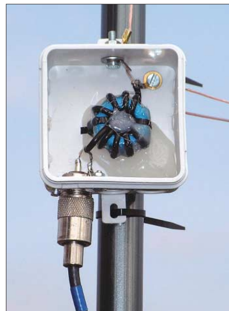
Bild 10: Anschlussdose der Angelrutenvariante der Antenne Fotos: DK7ZB
