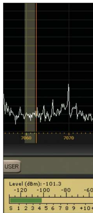
Bild 4: ... der sich beim Wechsel zur Magnetantenne auf S4 reduziert. Jetzt sind auch vormals im Rauschen versunkene Signale sicht- und hörbar. Bilder: DL1ABJ
