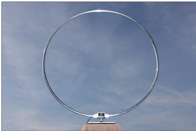
Bild 1: Der abgesetzte Aluminiumrahmen der Magnetantenne hat etwa 1 m Durchmesser.
