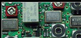
1. ZF: Drei Roofing-Filter bei 69,45 MHz
