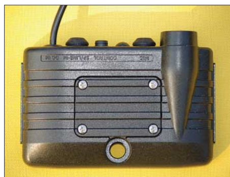
Bild 4: Das kompakte und flache Transceivergehäuse mit der großen Einloch-Bohrung
