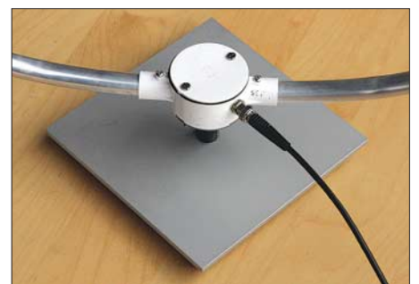
Bild 2: Die Rahmenenden laufen im Verstärkergehäuse zusammen. Als Zubehör ist ein Drehfuß erhältlich.
