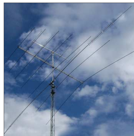
Bild 6: Die CX 3040 RD ist bei DL7VEE unter der LP7 montiert; ganz oben eine 6-m-Yagi.
